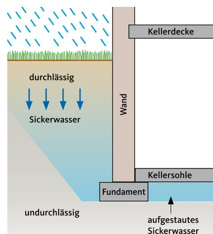
Abbildung 13: Beanspruchung durch aufstauendes Sickerwasser (Stauwasser)
