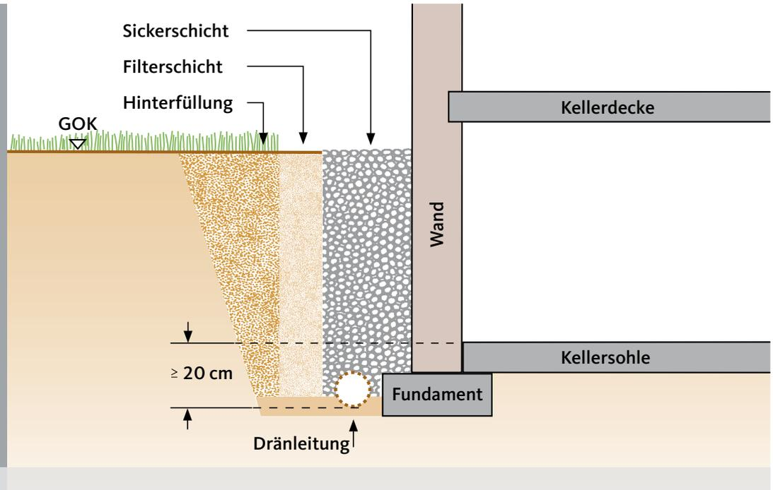
dem Gewässer bzw. dem Siel zu sichern (zu Rückstau siehe Kapitel „Schutz vor Rückstau aus dem Sielnetz“). Alternativ kann das Dränwasser bei guter Durchlässigkeit des Bodens auch in einem ausreichenden Abstand vom Haus über einen Sickerschacht infiltriert werden.
